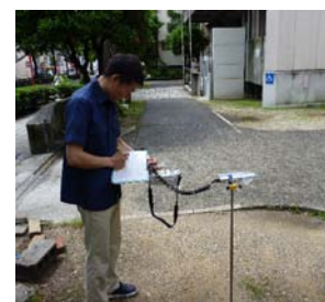
図2 サーベイメータによる測定：地上1m
