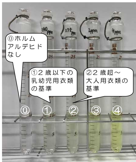
写真2 発色させたホルムアルデヒド標準溶液の濃度
