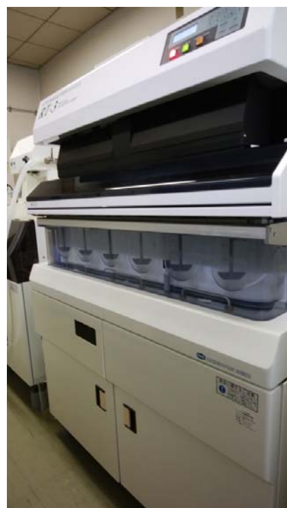
写真：当研究センターに導入された全自動溶出試験装置
